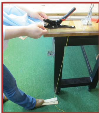
Käytä päätä, älä lompakkoa. Tässä yksinkertaisessa parannuksessa naru on kiinnitetty kotitekoiseen puupolkimeen ja pihteihin puristustyökäluna. Nyt operaattorin kädet ovat vapaat, samoin kuin hänen mielensä ajatella seuraavaa suurta parannusta.
