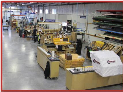
Проектировочный и производственный отсек на колёсиках станок в здании имеет колёсики. Это позволяет нам приспособиться к Проектировочный и производственный отсек на колёсиках любой ситуации, которая может возникнуть в процессе работы. Если нам нужно производственный отсек переместить поближе к отгрузочному, мы можем это сделать за считанные минуты.
