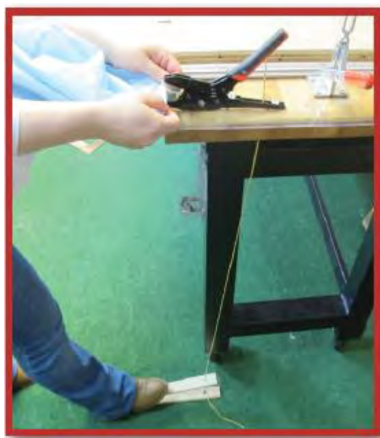
Bruk hodet, ikke lommeboka. Denne enkle forbedringen bruker en hyssing festet til en hjemmelaget pedal, og en tang som pressverktøy. Operatørens hender er frie, og det er også hodet hans, så han kan tenke på den neste store forbedringen.
