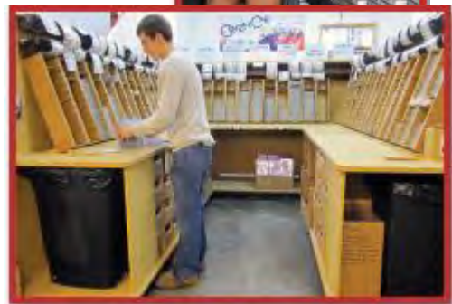
For en kontrast! Tidligere hadde vi hyllevis med masseproduserte varer og nå har vi rask og enkel flytproduksjon! Vi bygger akkurat det du trenger når du trenger det. Flytproduksjon er kontraintuitivt. Masseproduksjon virker raskere og mer effektivt, men det er i realiteten motsatt. I dette bildet viser vi en av våre mange U-formede celler i fabrikken vår.
