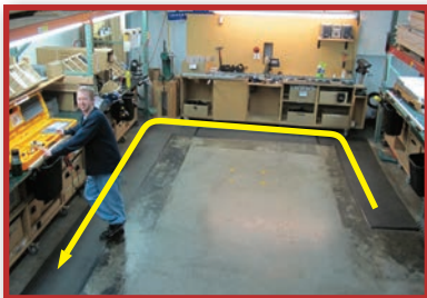
Neue U-förmige Zelle für Laserjams – eine Person verrichtet die Arbeit von vier Personen, fehlerlos.
