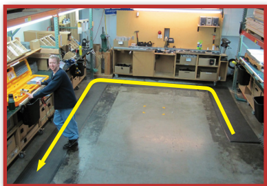
A nova célula em forma de U para as Laserjambs – uma pessoa a fazer o trabalho de quatro sem erros.
