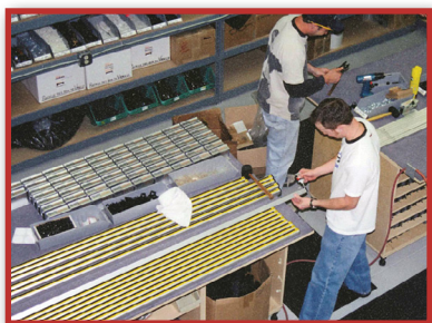
Grandes bancadas de trabalho para armazenar grandes lotes de trabalho. Se fosse cometido um erro, todo o lote teria de ser retrabalhado.
