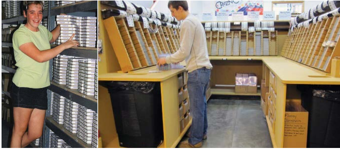
얼마나 대조적입니까! 배치로부터 빠르고 간단한 일체형 흐름으로! 필요할 때 필요한 양 만큼 생산한다. 일체형 흐름은 배치 생산은 더 빠르고 효율적으로 보이지만 사실은 그 반대이다. 이 사진은 우리 시설 전체에 있는 많은 U자형 린 셀 중 하나이다.
