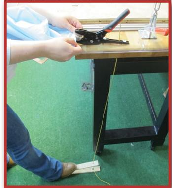
Köpfchen statt nur Zahlen verwenden. Bei dieser einfachen Verbesserung wird ein Strick mit einem selbst gefertigten Holzpedal und einer Zange als Crimp-Werkzeug verbunden. Der Benutzer hat nun beide Hände und auch seinen Kopf frei, um über die nächste großartige Verbesserung nachzudenken.
